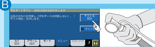
しばらくして「テスト開始」ボタンが表示されます。呼吸回路の送気口を塞ぎ「テスト開始」ボタンをタッチします。
