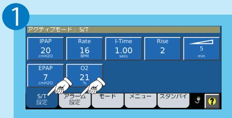
換気の設定変更は「〇〇（現在動作している換気モード）設定」タブを、アラームの設定変更は「アラーム設定」タブをタッチします。
