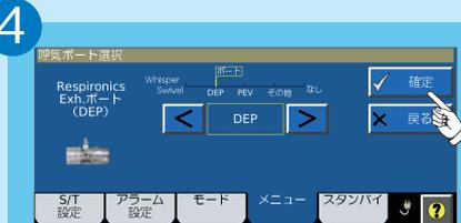
「確認」ボタンをタッチします。「PEV」と「その他」を選択した場合は、呼気ポートテスト(下項を参照)に移ります。
