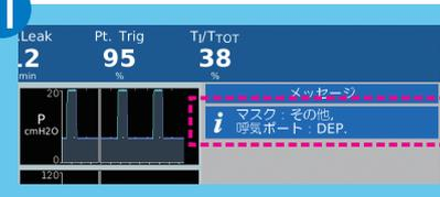
「メッセージ」リストに現在のマスクと呼気ポートの設定が表示されます。変更が必要な場合は以下の「マスクと呼気ポートの設定」を行ってください。
