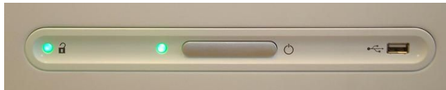
Hình 119: Nút |ON/OFF| (BẬT/TẮT) với đèn LED màu xanh lá cây
