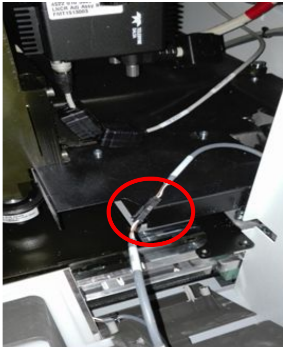
Hình 147: Cách đi dây đúng cho cáp đèn nền
