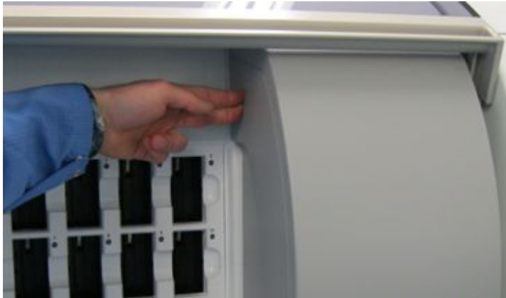
Hình 146: Nắp bộ di chuyển tiêu bản ở đúng vị trí
