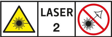
\lambda : 630-640nm P_{max} <1mW IEC 60825-1:2014 Figura 202 Etiqueta de advertencia del láser del mando de visualización
