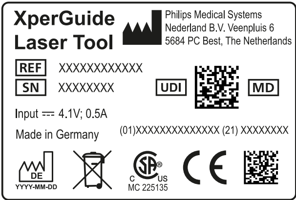
Figura 214 Etiqueta de la herramienta láser de XperGuide
