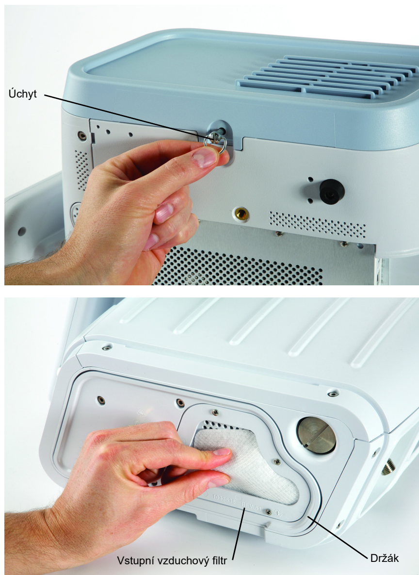
Obrázek 10-1: Výměna vstupního vzduchového filtru
