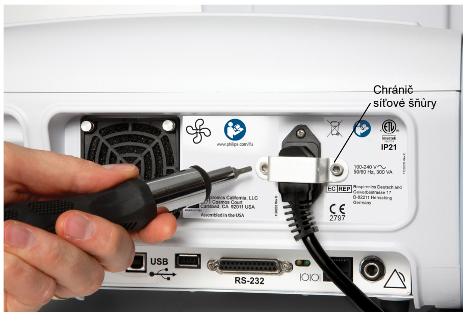
Obrázek A-5: Instalování chrániče síťové šňůry
