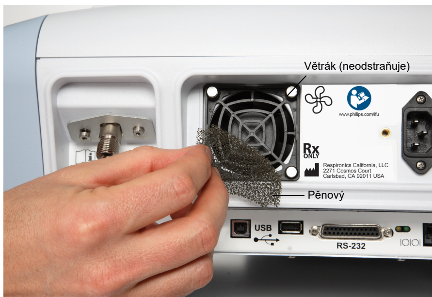
Obrázek 10-2: Výměna filtru větráku
