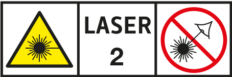
\lambda : 630-640nm P_{max} <1mW IEC 60825-1:2014 Figura 197 Etiqueta de advertencia del láser del mando de visualización
