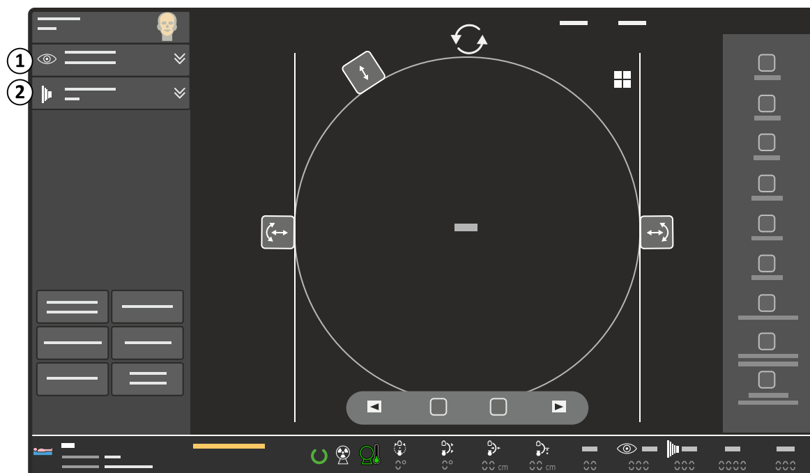
Hình 67 Các bộ mở rộng Fluoroscopy (Soi huỳnh quang) và Exposure (Chiếu xạ) trên màn hình cảm ứng C-arm
