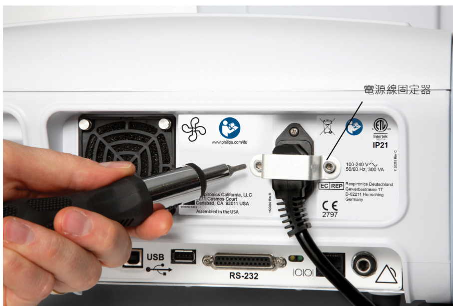
圖 A-5：安裝電源線固定器
