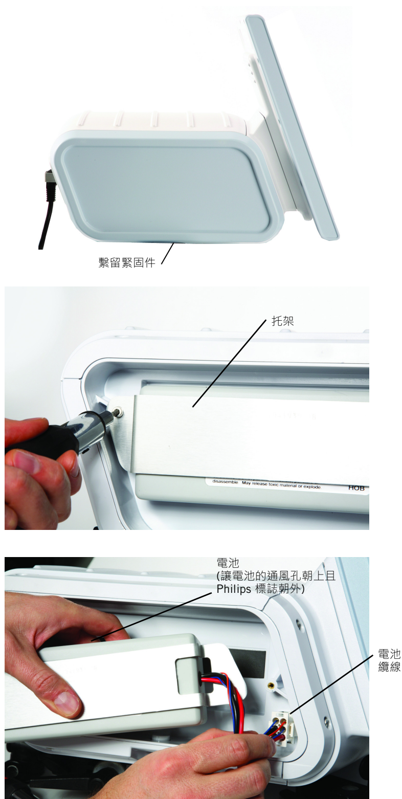
圖 A-3：安裝電池
