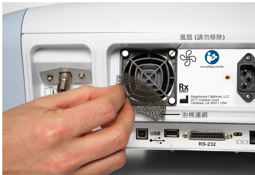
圖 10-2：更換冷卻風扇濾網
