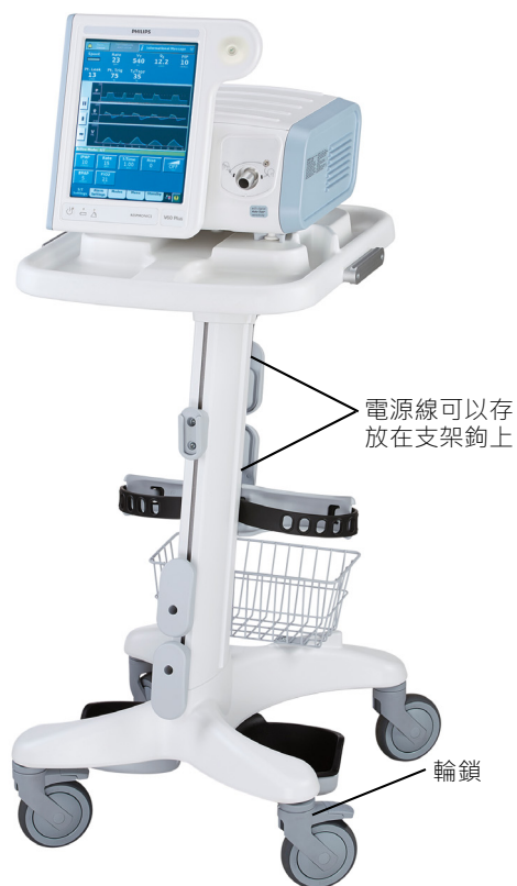
圖 A-2：位於支架上的 V60/V60 Plus 呼吸機
