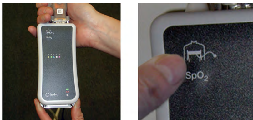
Fig. 19: À esquerda: Colocação da bateria de volta no respectivo compartimento. À direita: Pressionamento do campo de texto para navegar pelas redes.
