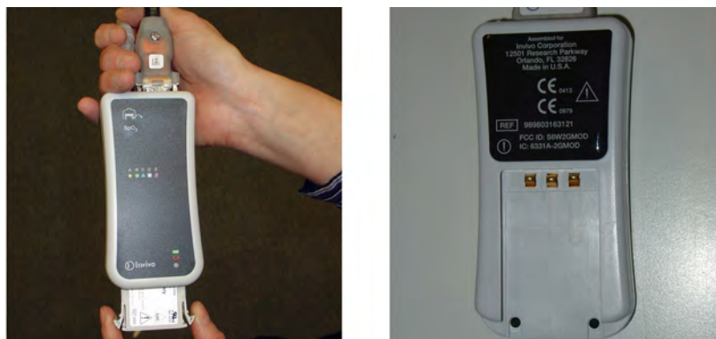
Fig. 18: À esquerda: Pressionamento das alavancas da bateria e deslizamento da bateria para fora do módulo da bateria sem fio. À direita: Módulo da bateria sem fio da parte de trás com bateria removida.
