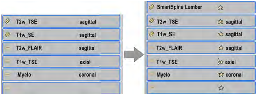
Fig. 85: Exemplo: Após aplicar as alterações, as geometrias foram substituídas por SmartGeometries e SmartSurvey foi adicionado ao ExamCard. Observe que a aquisição axial T1w_TSE é específica para o nível.
