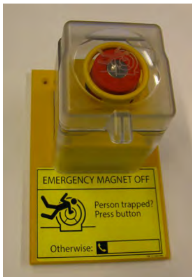
Fig. 2: Etiqueta e botão de desligamento de emergência do magneto.
