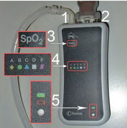
Fig. 17: Módulo de bateria de PPU sem fio. 1: Conector do cinto respiratório, 2: Conector da unidade de pulso periférico (PPU), 3: Indicador do tipo de dispositivo: VCG ou SpO 2 (no caso de PPU), 4: Indicação da rede atual, 5: Indicador do status da bateria
