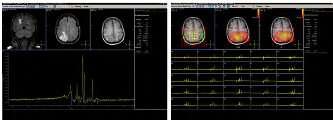
Fig. 145: Layout do SpectroView: Esquerda para Single Voxel (Voxel único) (SV), direita para Chemical Shift Imaging (Aquisição de imagens com deslocamento químico) (CSI).
