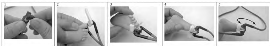
Fig. 24: Conexão do clipe descartável I ao sensor de SpO 2 da PPU.
