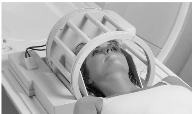
Fig. 31: Pronto para um exame de cabeça/cérebro com a bobina T/R Head.
