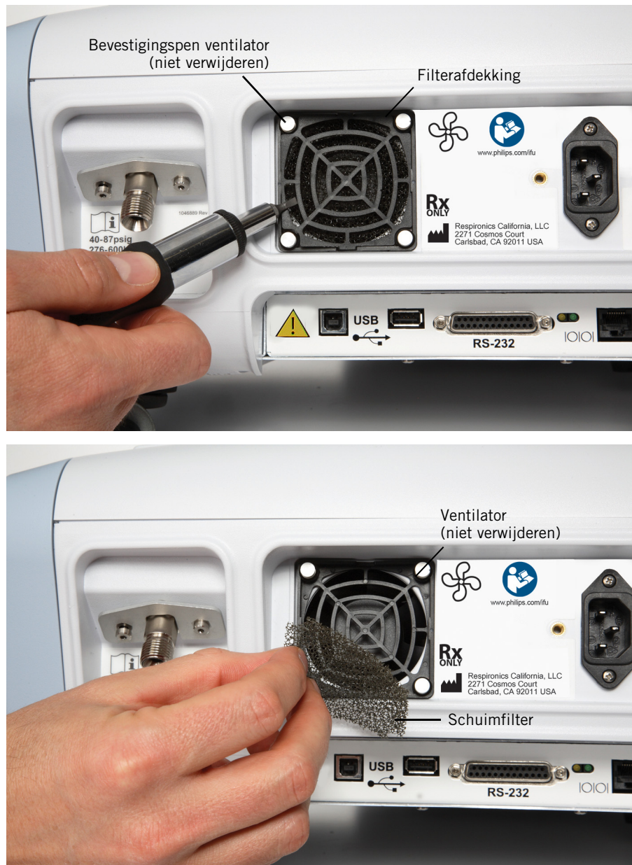
Afbeelding 10-2: Het koelventilatorfilter vervangen
