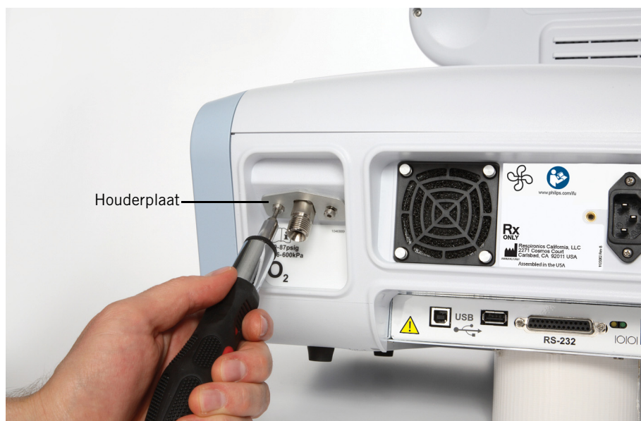
Afbeelding A-4: De zuurstofinlaataansluiting monteren
