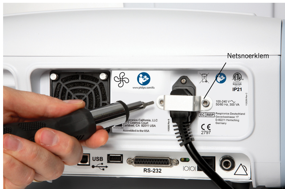
Afbeelding A-5: De netsnoerklem monteren
