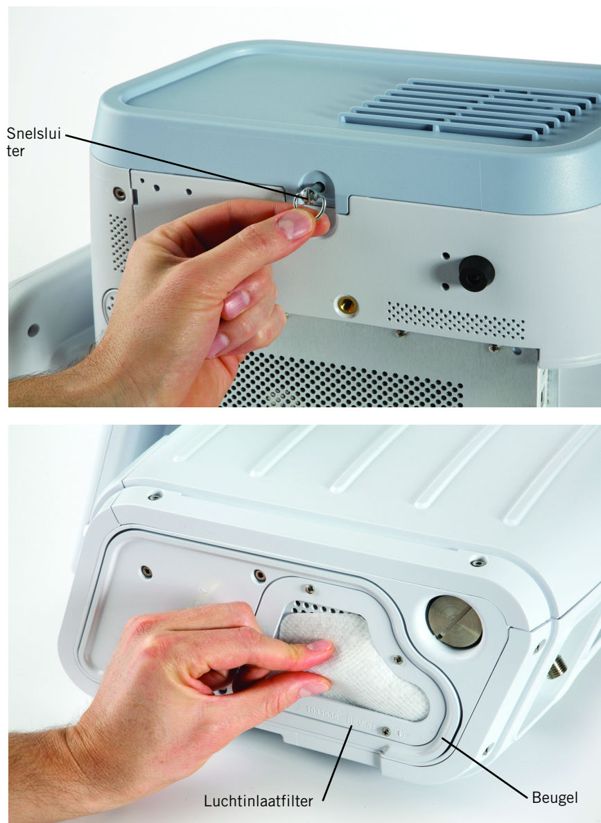
Afbeelding 10-1: Het luchtinlaatfilter vervangen
