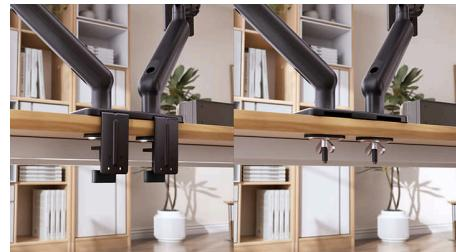
此显示器支架可通过两种方式安装：C 型夹安装或穿孔安装，支持桌板厚度 10 ~ 80 毫米。
