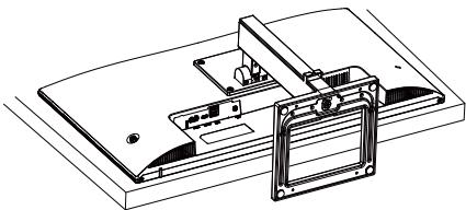
2. Remova os parafusos e separe o braço do monitor.
