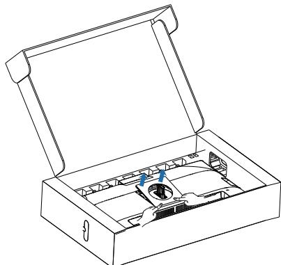
4. Solte os parafusos de montagem, retire a dobradiça.
