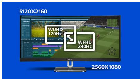
解锁巅峰性能，一款专为全场景打造的显示器。进行精细创意设计、多任务处理，或是追求沉浸式视觉体验时，可切换至 5120 x 2160 分辨率超高清 WUHD、120 Hz 刷新率模式；畅玩游戏时，可切换至 2560 x 1080 分辨率 WFHD、240 Hz 刷新率模式，尽享更流畅、更低延迟的操作体验。无论您沉浸于设计工作，还是在瞬息万变的对决中，这款双模式显示器都能根据您的工作与娱乐需求，实现清晰度与运行速度的理想平衡。
