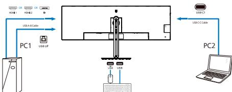
2. Aceda ao menu OSD. Aceda ao separador KVM e selecione “Auto”, “USB C” ou “USB up” para mudar a vista do monitor de um dispositivo para outro. Para mudar para outras vista de monitor, repita simplesmente este passo.
