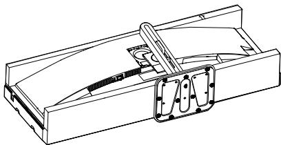
2. Lösen Sie die Montageschrauben, und trennen Sie dann die Halterung vom Monitor.
