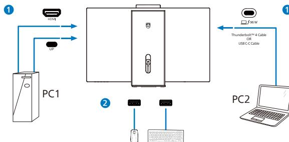
3. 輸入 OSD 功能表。前往 KVM 層級，選擇「自動」、「Thunderbolt」以切換裝置之間的周邊設備控制權。只需重複此步驟，即可使用一組周邊設備切換控制系統。
