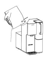
加入3公升(約半箱)市政自來水,再加入檸檬酸除垢劑30g,攪拌溶解後放置2小時,切勿把原水箱放回機器。
