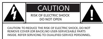
Der „Blitz“ zeigt an, dass nicht isoliertes Material im Gerät einen Stromschlag verursachen kann. Bitte entfernen Sie die Verkleidung nicht, um die Sicherheit aller Personen in Ihrem Haushalt zu gewährleisten.
