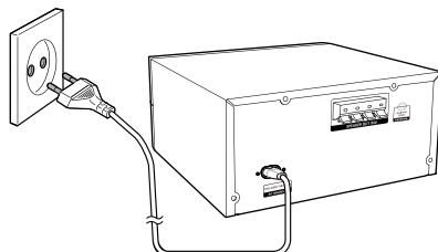
Conecte el cable de alimentación a la toma de corriente.
