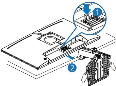
3. Presione hacia abajo en la parte media inferior de la cubierta de VESA y el otro lado de la cubierta se abrirá.
