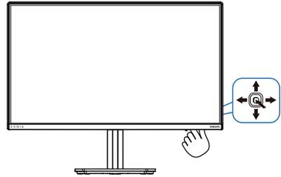
1. Deslice el botón de encendido hacia la izquierda para iniciar el menú de visualización en pantalla de SmartImage.
