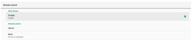
Cochez la case « Enable (Activé) » pour activer ou désactiver le service client de télécommande. Le paramètre par défaut est « Enabled (Activé) ». Pour utiliser la fonction de télécommande, l'appareil doit être lié au serveur de télécommande.
