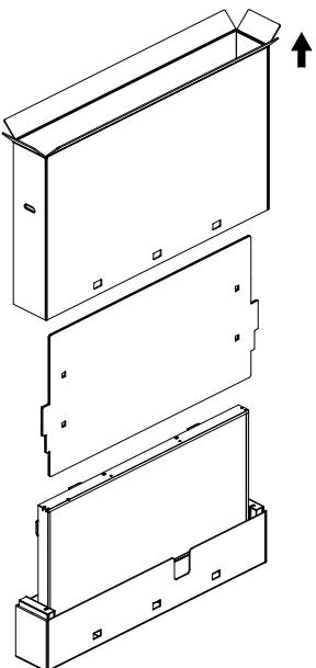
4. 当显示器仍在底部缓冲垫中时，安装壁挂套件(\*)。(\* 需单独购买)
