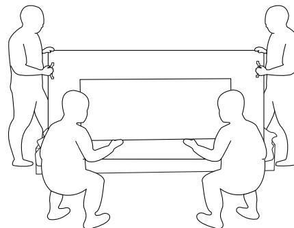
6. 小心移动显示器，直到底部手柄脱离包装盒。两侧应有两人握住 4 个把手，另外两人则站在显示器的前后支撑底部。
