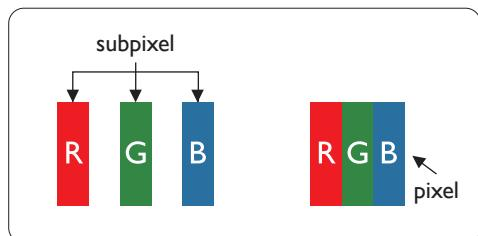
一个像素或像元由基色为红、绿、蓝的三个子像素构成。许多像素在一起形成一个图像。当一个像素的所有子像素都变亮时，三个不同颜色的子像素一起作为一个白色像素显示。当所有子像素都变暗时，三个不同颜色的子像素一起作为一个黑色像素显示。子像素的其它亮、暗组合将显示为一个其它颜色的像素。
