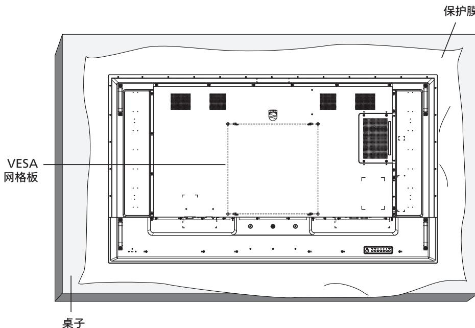
1. 准备一个比显示屏大的平坦水平表面，在上面铺上厚保护垫，以免在操作时划伤屏幕。
