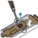
6. シェーバー本体の側面にマイナスドライバーを差し込んで、本体のツメを外します。
