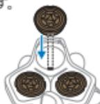
5. 保持板をシェービングヘッドに再度取り付け、時計回りに回します。
