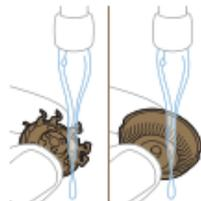
6. 内刃と外刃をシェービングユニットに取り付けます。詳しい手順については、「刃の交換」(P.26)をご参照ください。
