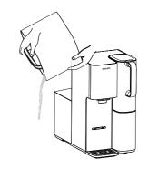
② 向原水箱加入約 30g(1 oz)檸檬酸,再加入自來水至 3L(約3.2 qt) 水位,輕輕攪拌後靜置約 2 小時。
