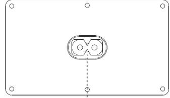
AC IN (مدخل التيار المتردد): قم بتوصيل كابل التيار المتردد للحصول على مصدر الطاقة.
