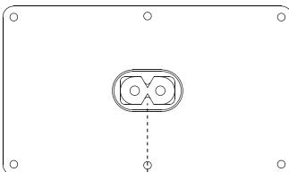
AC IN (AC IZLAZ): Povežute strujni kabl da obezbjedite napajanje.
