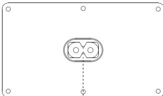
AC IN (ULAZ NAPAJANJA): Povežite kabel za izmjeničnu struju kako biste dobili napajanje.
