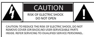
Questo "fulmine" indica che il materiale non isolato all'interno del dispositivo potrebbe causare una scossa elettrica. Per la sicurezza di tutti i membri della famiglia, non rimuovere la copertura.
