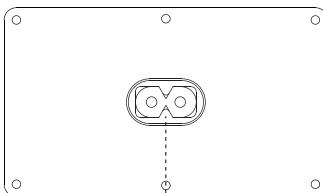
AC IN (ΕΙΣΟΔΟΥ ΡΕΥΜΑΤΟΣ AC): Συνδέστε το καλώδιο AC για να αποκτήσετε τροφοδοσία.
