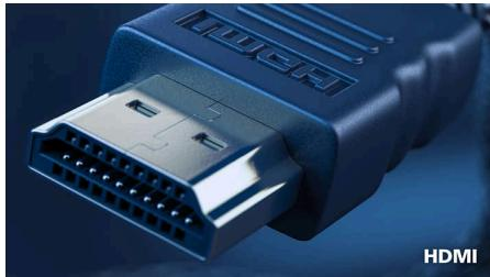
Un appareil compatible HDMI est équipé de l'ensemble du matériel requis pour accepter une source HDMI (High-Definition Multimedia Interface). Un seul câble HDMI suffit pour transmettre des signaux audio et vidéo numériques de haute qualité provenant d'un PC
