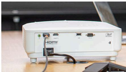
Проектор ProPix 860 поддерживает входные интерфейсы HDMI (2 шт.) для простой интеграции со старыми системами, которые зачастую используются в образовательных учреждениях и корпоративных пространствах. Также он оснащен портами RS232 для профессиональных систем AV-контроля, портом USB и линейным аудиовыходом 3,5 мм для внешних звуковых решений.
