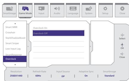
Em seguida, mantenha pressionado o botão esquerdo do menu no monitor enquanto volta a ligar o cabo de alimentação. Mantenha o botão pressionado até que o ecrã se ligue. Isso irá desativar a função Overclock e o monitor voltará à frequência de atualização predefinida.
