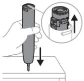
Dopo avere allontanato le lingue dalla parete, staccate il gruppo interno dal tubo di alloggiamento, capovolgendo il manico e premendo con decisione l'albero metallico su una superficie solida (non sbattete il manico con forza). Se i componenti interni non escono facilmente dal tubo di alloggiamento, verificare di aver completato il passaggio 5 descritto in precedenza.
