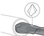
**3** Zapojte nabíjací kábel do nabíjacieho portu. Omotajte malú handričku okolo najhrubšej časti nabíjacieho kábla.
