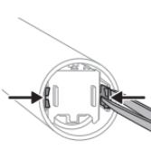
**7** Тілшелер қабырғадан ажыратылғаннан кейін, тұтқаны аударып, металл өзекті қатты бетке нық басу арқылы ішкі механизмді қаптама түтігінен босатыңыз (тұтқаны құшпен соғып ұрманыңыз). Егер ішкі компоненттер корпусынан оңай ажырамаса, жоғарыдағы 5-қадамды орындағаныңызды қайта тексеріңіз.
