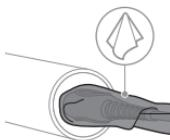
**3** Ligue o cabo de carregamento à porta de carregamento. Enrole um pano pequeno à volta da parte mais grossa do cabo de carregamento.
