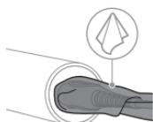
4 Fassen Sie den mit dem Tuch umwickelten Bereich mit einer Zange. Drehen Sie die Abdeckkappe dann gegen den Uhrzeigersinn nach links.
