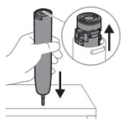
**7** Nakon što jezičke udaljite od stijenke, otpustite unutarnji sklop iz cijevi kućišta okretanjem drške i čvrstim pritiskom metalne osovine na čvrstu površinu (nemojte snažno udarati drškom prema dolje). Ako se unutarnji dijelovi ne otpuštaju lako iz cijevi kućišta, još jednom provjerite jeste li dovršili prethodno navedeni peti korak.
