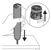
**7** Odată ce clemele sunt departe de perete, eliberați ansamblul intern din tubul carcasei inversând mânerul și apăsând ferm axul metalic pe o suprafață solidă (nu trântiți mânerul cu forță). Dacă componentele din interior nu se eliberează cu ușurință din tubul carcasei, asigurați-vă că ați respectat instrucțiunile de la pasul 5.
