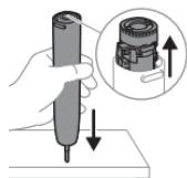
**7** Kada jezičke udaljiš od zida, otpustite unutrašnji sklop iz cevi kućišta tako što ћete obrnuti ručku i čvrsto pritisnuti metalnu osovinu na čvrstu površinu (ne lupajte ručku silom). Ako unutrašnje komponente ne mogu lako da se odvoje od cevi kućišta, proverite da li ste dovršili gore navedeni korak 5.
