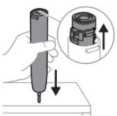
**7** Keď sú jazyčky oddelené od steny, uvoľnite vnútornú zostavu z krycej trubice tak, že prevráťte rukoväť a pevne pritlačíte kovový hriadeľ na pevný povrch (nebúchajte rukoväťou). Ak sa vnútorné komponenty z krytu neuvoľnia ľahko, dôkladne skontrolujte, či ste dokončili krok 5, ktorý je uvedený vyššie.
