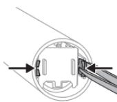
**6** Utilize uma pinça ou uma ferramenta de plástico para afastar as duas abas de retenção das paredes internas da pega.
