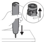
Um die inneren Komponenten aus dem Gehäuserohr zu lösen, sobald die Laschen entfernt wurden, drehen Sie das Handstück um und drücken Sie den Metallschaft fest auf eine feste Oberfläche (schlagen Sie das Handstück nicht mit Gewalt auf). Wenn die Innenteile sich nicht leicht aus dem Gehäuserohr lösen lassen, stellen Sie sicher, dass Sie Schritt 5 korrekt ausgeführt haben.
