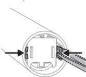
**6** Odată ce clemele sunt departe de perete, eliberați ansamblul intern din tubul carcasei inversând mânerul și apăsând ferm axul metalic pe o suprafață solidă (nu trăntiți mânerul cu forță). Dacă componentele din interior nu se eliberează cu ușurință din tubul carcasei, asigurați-vă că ați respectat instrucțiunile de la pasul 5.
