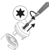
**3** Pomocou skrutkovača typu torx odskrutkujte a vyberte (proti smeru hodinových ručičiek) skrutku zo základne rukoväte zubnej kefky.
