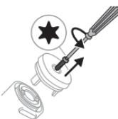
**3** За допомогою викрутки зі шліцом «зірочка» викрутіть і вийміть (проти годинникової стрілки) гвинт, розміщений у нижній частині ручки зубної щітки.
