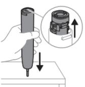
**7** Trageți ușor de ansamblul interior pentru a-l demonta de la baza tubului carcasei.
