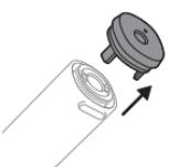
**5** Pinzetou nebo nějakým plastovým nástrojem vypačte dva upevňovací jazyčky z vnitřních stěn rukojeti.
