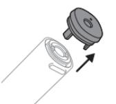
**4** Uklonite završni čep s baze četkice za zube. Ako je završni čep čvrsto postavljen i ne može se lako izvući iz cijevi kućišta, upotrijebite plastični alat za hvatanje kako biste odvojili čep od cijevi kućišta.
