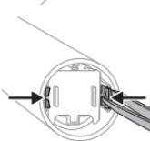
**6** Keď sú jazýčky oddelené od steny, uvoľnite vnútornú zostavu z krycej trubice tak, že prevráťte rukoväť a pevne pritlačíte kovový hriadeľ na pevný povrch (nebúchajte rukoväťou). Ak sa vnútorné komponenty z krytu neuvoľnia ľahko, dôkladne skontrolujte, či ste dokončili krok 5, ktorý je uvedený vyššie.
