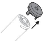
**4** הסר את כיסוי הקצה מהבסיס של מברשת השיניים. אם כיסוי הקצה הדוק ולא משתחרר בקלות משופורת המארז, הייעזר בכליל פתיחה מפלסטיק כדי להפריד את כיסוי הקצה משופורת המארז.
