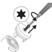
**3** Cu ajutorul unei șurubelnite Torx, deșurubați și scoateți (în sens invers acelor de ceasornic) șurubul de la baza mânerului periuței de dinți.
