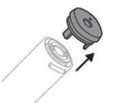
**5** За допомогою пінцета або пластикового важеля від'єднайте два фіксувальні язички від внутрішніх стінок ручки.
