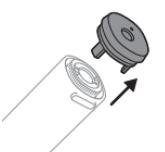
**5** Pomocou pinzety alebo plastového páčidla vypáčte dva prídržné jazýčky od vnútorných stien rukoväte.
