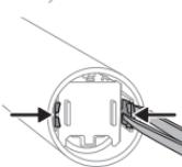
**6** Коли язички буде відхилено від стінок, від'єднайте внутрішній блок від корпусу. Для цього переверніть ручку й міцно притисніть металевий стрижень до твердої поверхні (не стукайте ручкою із зусиллям). Якщо їх важко вийняти з корпусу, перевірте, чи виконано крок 5, зазначений вище.
