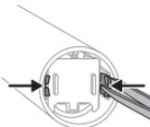
**6** Тілшелер қабырғадан ажыратылғаннан кейін, тұтқаны аударып, металл өзекті қатты бетке нық, басу арқылы ішкі механизмді қаптама тутігінен босатыңыз (тұтқаны құшпен соғып ұрмашы). Егер ішкі компоненттер корпусынан оңай ажырамаса, жоғарыдағы 5-қадамды орындағаныңызды қайта тексеріңіз.
