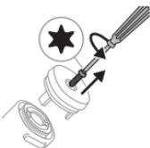
**3** Pomoću torx odvijača odvrnite i uklonite (u smjeru suprotnom od smjera kretanja kazaljke na satu) vijak s baze drške četkice za zube.
