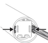
**6** Kada jezičke udaljiš od zida, otpustite unutrašnji sklop iz cevi kućišta tako što ćete obrnuti ručku i čvrsto pritisnuti metalnu osovinu na čvrstu površinu (ne lupajte ručku silom). Ako unutrašnje komponente ne mogu lako da se odvoje od cevi kućišta, proverite da li ste dovršili gore navedeni korak 5.
