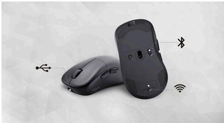
此鼠标的高速无线连接功能提供专业连接并免除了线缆牵绊。此外，游戏玩家可以通过 USB 接收器或蓝牙连接等多种方法连接到设备，只需滑动开关即可在设备之间切换。此鼠标还配备 USB 连接。
