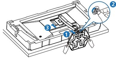
3. Setelah memasang dasar, tegakkan monitor dengan kedua tangan untuk menyangga monitor dengan kuat menggunakan styrofoam. Sekarang Anda dapat menarik keluar styrofoam. Ketika Anda menarik keluar styrofoam, jangan memencet panel untuk menghindari kerusakan panel.
