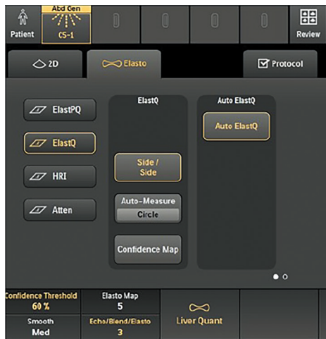
Figure 8 Écran tactile Elasto affichant le bouton Auto ElastQ. L'activation de ce bouton permet au système de sélectionner automatiquement les images et les emplacements pour la mesure de la rigidité hépatique.
