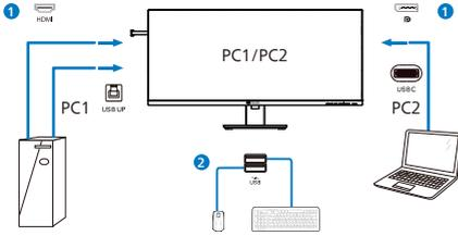
3. Accédez au menu OSD. Accédez à la section KVM et sélectionnez "Auto", "USB C" ou "USB up" pour basculer le contrôle des périphériques d'un appareil à l'autre. Répétez simplement cette étape pour commuter le système de contrôle à l'aide d'un seul ensemble de périphériques.
