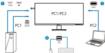
3. Accédez au menu OSD. Accédez à la section KVM et sélectionnez "Auto", "USB C" ou "USB up" pour basculer le contrôle des périphériques d'un appareil à l'autre. Répétez simplement cette étape pour commuter le système de contrôle à l'aide d'un seul ensemble de périphériques.
