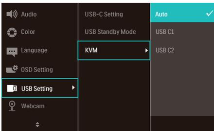
若要利用DP和/或HDMI线将信号输入至您的设备，请将处于USB上行方向的USB线连接至USB-C1和USB-C2端口。
