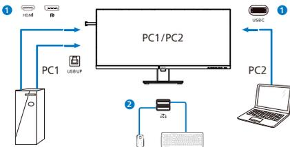
3. Rufen Sie das Bildschirmmenü auf. Rufen Sie die KVM-Ebene auf und wählen Sie zum Wechseln der Peripheriesteuerung von einem Gerät zum anderen „Auto“, „USB C“ oder „USB up“ (USB-Upstream). Wiederholen Sie diesen Schritt einfach, wenn Sie das Steuersystem über ein Set Peripheriegeräte umschalten möchten.
