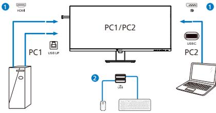
3. Rufen Sie das Bildschirmmenü auf. Rufen Sie die KVM-Ebene auf und wählen Sie zum Wechseln der Peripheriesteuerung von einem Gerät zum anderen „Auto“, „USB C“ oder „USB up“ (USB-Upstream). Wiederholen Sie diesen Schritt einfach, wenn Sie das Steuersystem über ein Set Peripheriegeräte umschalten möchten.
