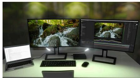
Lančano povezivanje vam omogućava da pokrećete više monitora i uređaja pomoću jednog Thunderbolt porta na laptopu.
