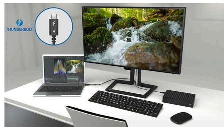
Ovaj Philips monitor sa baznom stanicom ima Thunderbolt™ 4 vezu. U poređenju sa standardnim USB-C monitorima, tehnologija Thunderbolt™ 4 pruža munjevitu brzinu prenosa podataka od 40 Gb/s, za video visoke rezolucije, prenos preko više strimova za lančano povezivanje, napajanje do 96 W za spoljne uređaje i stabilnu Ethernet vezu od 1 Gb/s.
