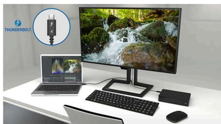
这款飞利浦扩展坞显示器配备 Thunderbolt™ 4 接口。与传统 USB-C 显示器相比，Thunderbolt™ 4 技术可实现高达 40Gbps 的极速数据传输，支持高分辨率视频、多流传输和串联连接，能为外接设备提供最高 96W 的电力输出，并提供稳定的 1Gbit/s 以太网连接。
