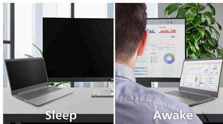
这款显示器的 PowerSensor 2 智能感应功能可检测用户与屏幕的远近变化，从而降低能耗。请先将 OSD 菜单设置为“用户”模式，并在 Windows 11
