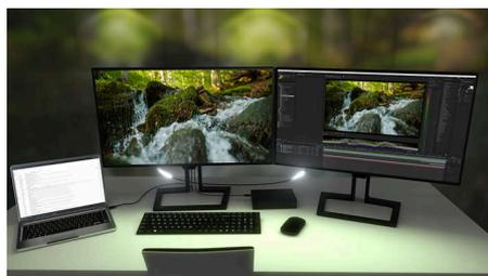
菊花链允许您从笔记本电脑上的单一 Thunderbolt 端口驱动多显示器和设备。从笔记本电脑的 Thunderbolt 端口连接到此显示器，然后可以从此显示器上的第二个 Thunderbolt 端口连接到第二个 4K 显示器。
