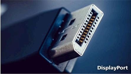
DisplayPort 是由電腦連接到顯示器的數碼連結，毋需任何轉換。它的能力比 DVI 高，能全面支援長達 15 米的電線及高達每秒 10.8 Gbps 的資料傳輸速率。在高效能和零延遲的情況下，您會得到最快的成像及畫面刷新率 - 令 DisplayPort 不單在一般
