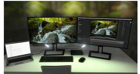
Daisy-Chaining ermöglicht es Ihnen, mehrere Monitore und Geräte über einen einzigen Thunderbolt-Anschluss an Ihrem Laptop zu betreiben. Verbinden Sie den Thunderbolt-Anschluss Ihres Laptops mit diesem Monitor, und verbinden Sie dann den zweiten Thunderbolt-Anschluss dieses Monitors mit einem zweiten 4K-Monitor.
