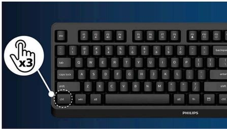
Im Gegensatz zu herkömmlichen integrierten KVM-Monitortasten ermöglicht das intelligente KVM das Umschalten zwischen Quellen mit einem Klick auf der Tastatur. Wenn alle Geräte ordnungsgemäß verbunden sind, können Benutzer einfach zwischen den Quellen wechseln, indem sie dreimal auf die Strg-Taste klicken.
