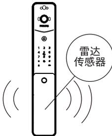
**触发机制:** 当有可疑人员在门外正前方视角范围内, 逗留时长超过设定值将会触发徘徊报警;
