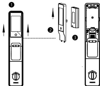
门锁的基础工作电源为一块5000mAh 锂聚合物电池。
