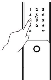
当门锁自动上锁功能偶发故障，不能自动上锁时。关门后，请按门锁面板上的上锁键完成上锁。
