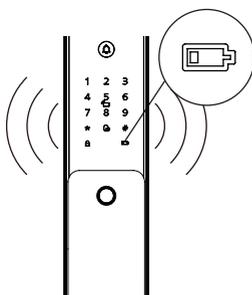
**触发机制:** 当系统唤醒后，将自动检测电池电压，当电池电压不足时，发出警报，提示您及时更换电池
