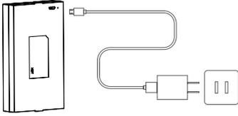
将电池从门锁上取下，使用充电线给锂聚合物电池充电。
