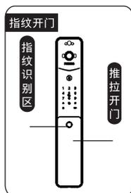
① 将已经添加指纹的手指以正确的方式放在把手后侧的指纹传感器上；
