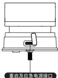
当电池电压不足，无法从外部开启时，您可以通过使用5V充电宝，作为应急电源给门锁上电。打开门锁后，请立即更换电池。如遇系统死机，在门外无法开门时，也可以使用5V充电宝给门锁上电，上电后系统自动重启。
