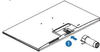
2. Sujete el soporte de la base del monitor con ambas manos e inserte firmemente el soporte de la base en la columna de la misma.
