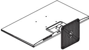
2. Presione el botón de liberación para desmontar la columna de la base.
