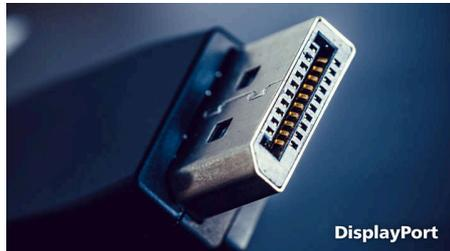
DisplayPort 是由電腦連接到顯示器的數碼連結，毋需任何轉換。它的能力比 DVI 高，能全面支援長達 15 米的電線及高達每秒 10.8 Gbps 的資料傳輸速率。在高效能和零延遲的情況下，您會得到最快的成像及畫面刷新率 - 令 DisplayPort 不單在一般
