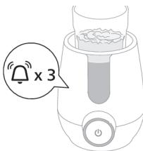
**12** El artefacto pasa al **modo de mantener temperatura** y se apaga automáticamente después de 60 minutos (incluido el tiempo de calentamiento).
