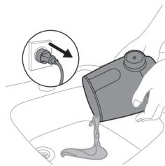
**10** Laissez l'eau refroidir, puis débranchez l'appareil avant de vider l'eau vers le côté de l'évier afin d'éviter d'en renverser sur le bouton ou la fiche du cordon d'alimentation.
