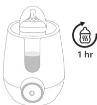
**7** L'appareil passe en **mode de maintien au chaud** et s'éteint automatiquement au bout d'environ 60 minutes (incluant le temps de réchauffage).
