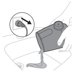
Deje enfriar el agua y, luego, desenchufe el artefacto y vierta el agua por un lado en el lavabo para evitar derrames en la perilla o el cable de alimentación.
