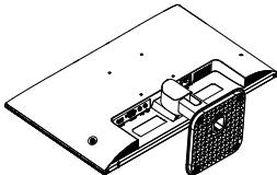
2. Apăsați pe clamele pentru blocare pentru a demonta suportul din șanțul special.
